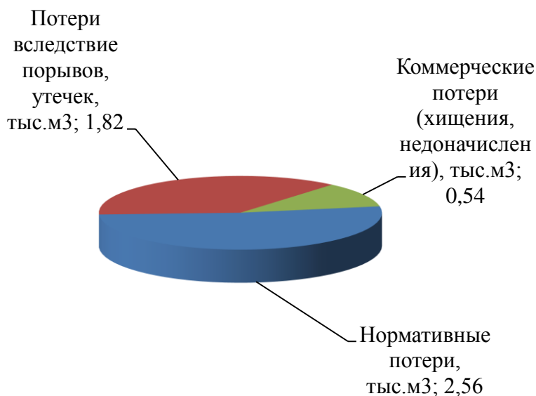
Рисунок 6 – Структурные составляющих потерь питьевой воды при ее производстве и транспортировке
